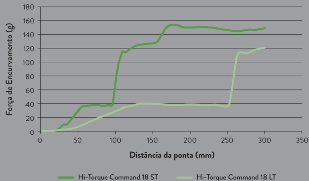
Hi-Torque Command 18 ST tem 10cm de ponta de nitinol proporcionando durabilidade e suporte.
